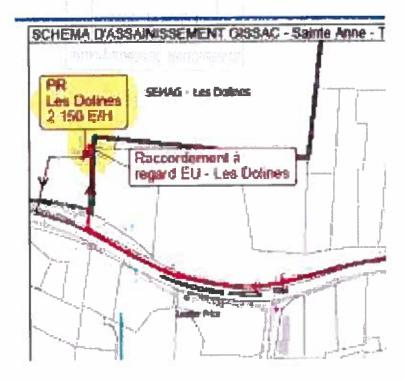
Mise en œuvre depuis ce poste de refoulement « les dolines », d'une conduite en refoulement privée DN 125 d'abord le long de la RN puis sur la première portion de la Rue de l'habitation jusqu'au regard du lotissement de Poirier de Gissac permettant un raccordement sur le réseau gravitaire. Le linéaire de conduite en refoulement est estimé à 790 ml.
